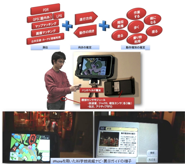
図2 iPhone と歩行者デッドレコニング(PDR)モジュールからなる科学ミュージアムナビ・ガイドシステム
