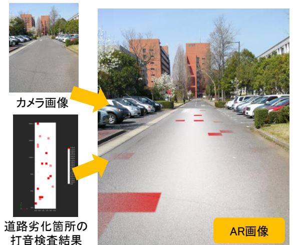
インフラ整備支援 (道路整備のための、内部劣化箇所の提示)
